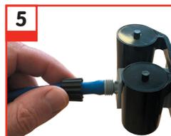
Retira la rosca. Inserta a través de la rosca la manguera de 9mm y acoplarla a la boquilla de la AQUAvalve5.
