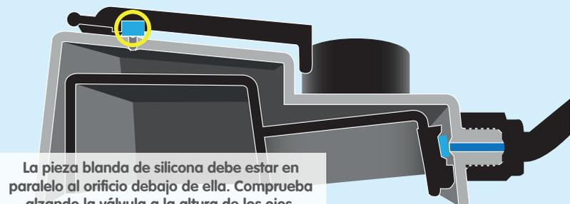
La pieza blanda de silicona debe estar en paralelo al orificio debajo de ella. Comprueba alzando la válvula a la altura de los ojos.
